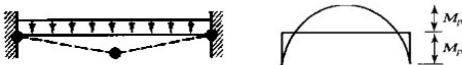
شکل (۱۳): ادامه‌ی بازتوزیع لنگر و تشکیل سومین مفصل پلاستیک در وسط دهانه و ناپایداری سازه
