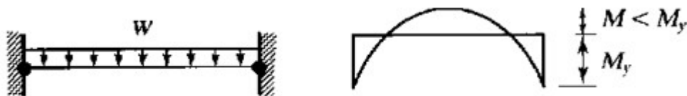
شکل (۱۲): تشکیل مفاصل پلاستیک در دو انتهای تیر و شروع فرآیند بازتوزیع لنگر
