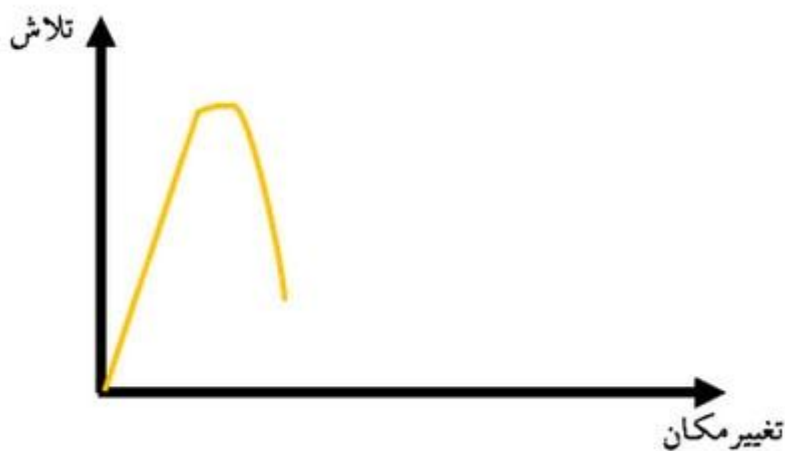
(شکل ۱۳) رفتار ترد و شکننده المان سازه
