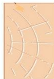
شکل (۴): شکل ساده شده وضعیت تارهای مقطع بعد از تغییر شکل خمشی
