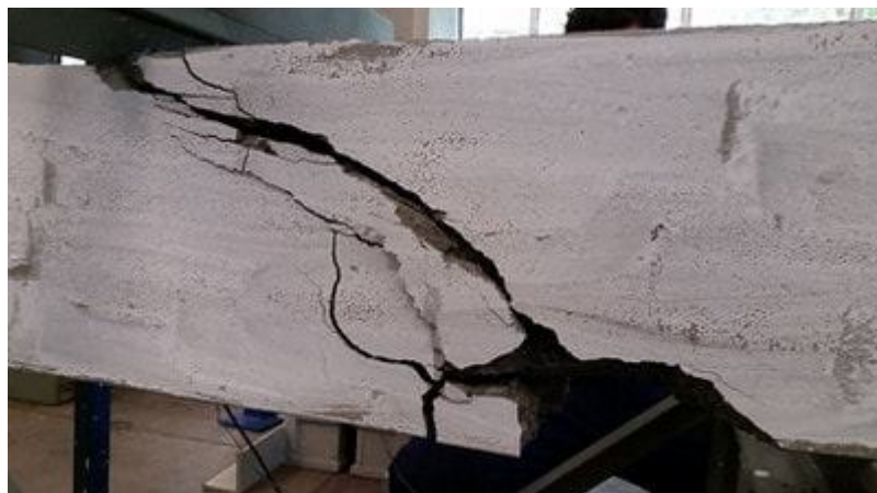
(شکل ۱۴) رفتار ترد و شکننده یک تیر بتن مسلح تحت برش
